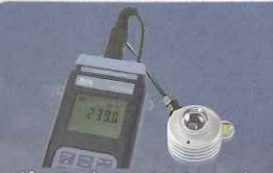
ポータブル日射計・ロガー HD2102.2 日射量直読+記録
