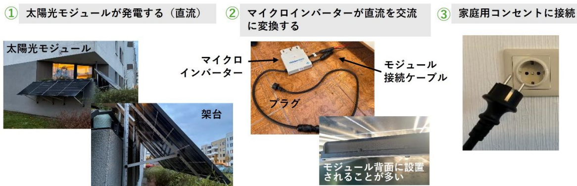
図 1：プラグインソーラーの基本構造と動作原理
