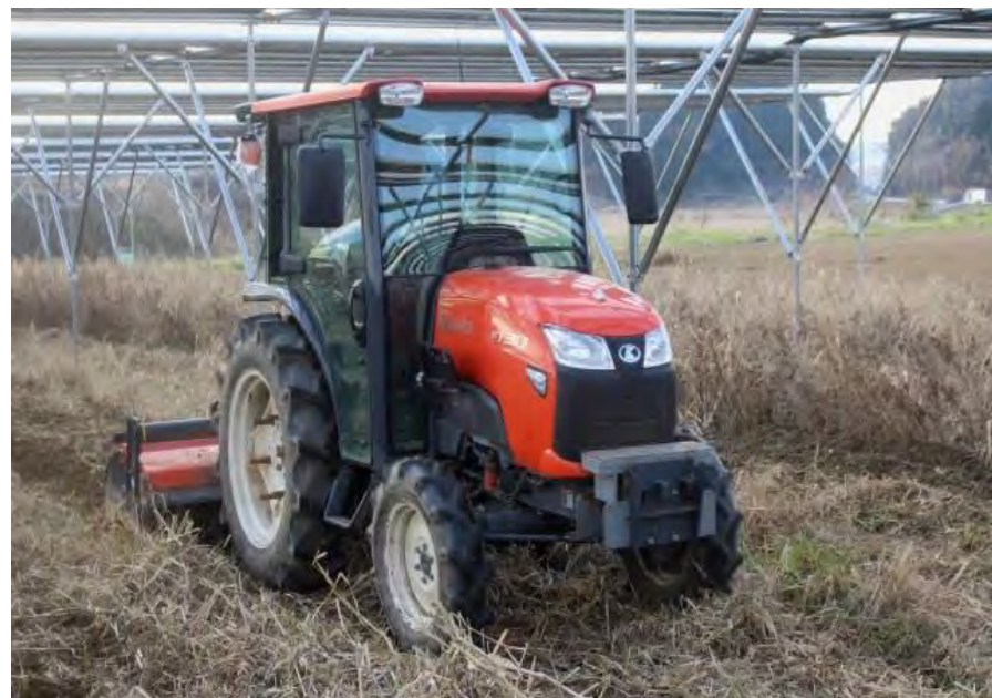
パネル下でのトラクターによる 耕運作業の様子
