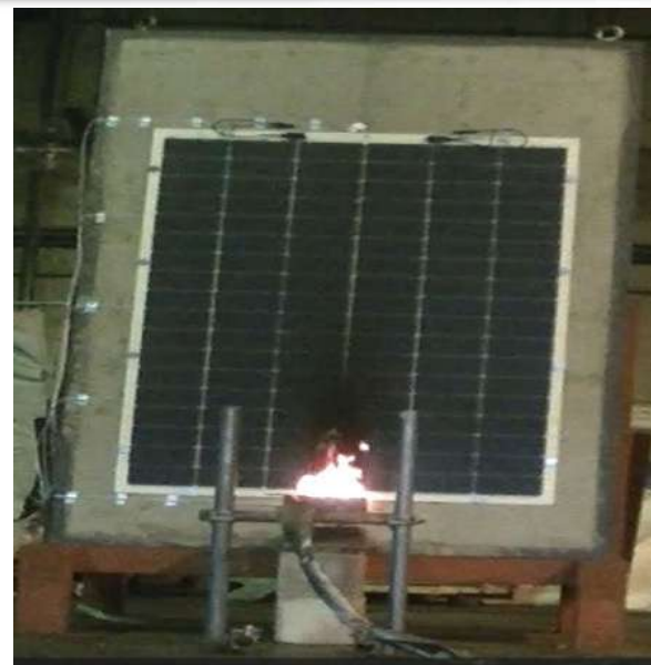
③ バーナ除去後の燃烧状況
