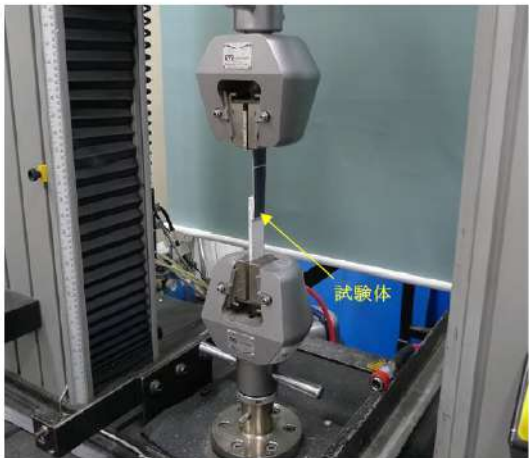
写真4 試験体設置状況の一例（せん断強さ）
