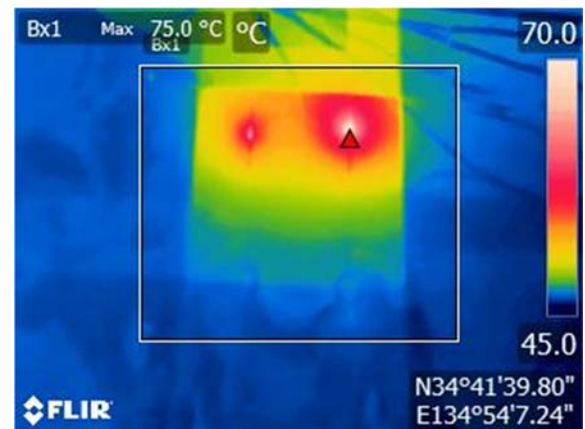
図 4.R3.8-8 #02-09 に接続されたあるモジュールの表面温度分布(裏側)の近接写真
