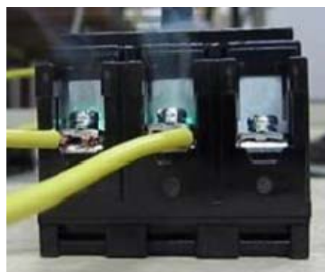
図 3.4-1 AC ブレーカ利用による事故例
