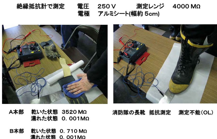
図 B4.1-1 消防隊員装備品の抵抗測定実験写真
