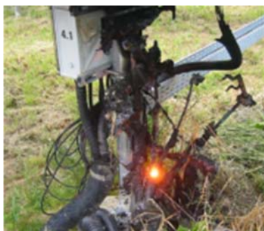
図 3.4-4 樹脂製における事故拡大例
