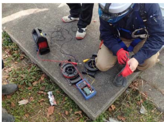
図 4.R3.10-2 地上で接地抵抗を測定している様子
