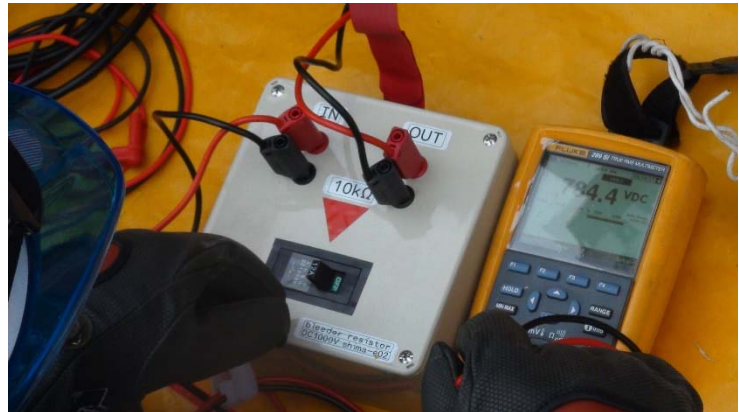
図 4.R3.6-12 ブリーダ電圧の測定
