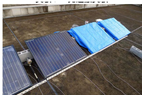
図 遮光効果の観測 2Ωの負荷抵抗を設置 (右から、ブルーシート2枚、ブルーシート1枚、普通モジュール)
