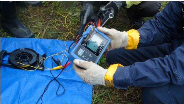
図 4.R3.1-2 接地抵抗を測定している様子
