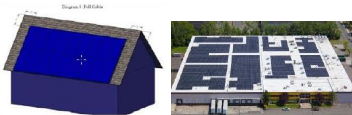
図 2.6.3-3 米国 IFC2012 に準拠した PV 設置例(左:住居用, 右:商業用陸屋根)
