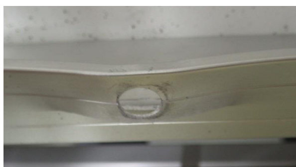
図 3.2.1-5 砂袋による終局耐力試験，二種類の破壊形態
