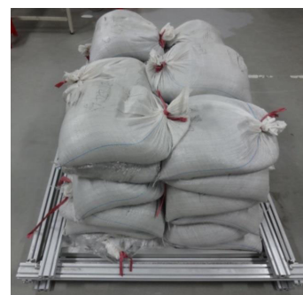
図 3.2.1-4 砂袋による終局耐力試験
