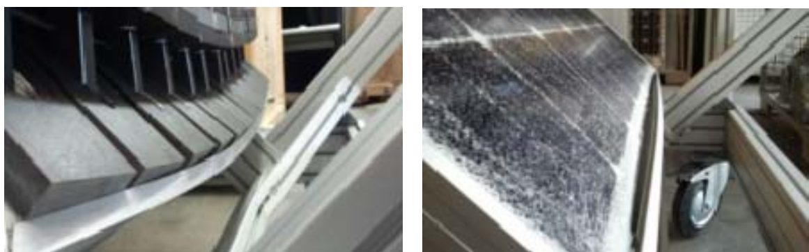
図 A.3-2 \sin 荷重による破壊例(出典 TUV ラインランド)
