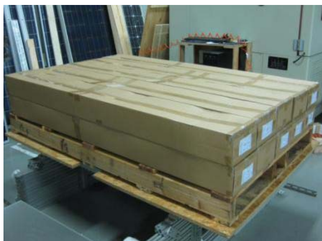
図 3.2.1-3 木材による終局耐力試験
