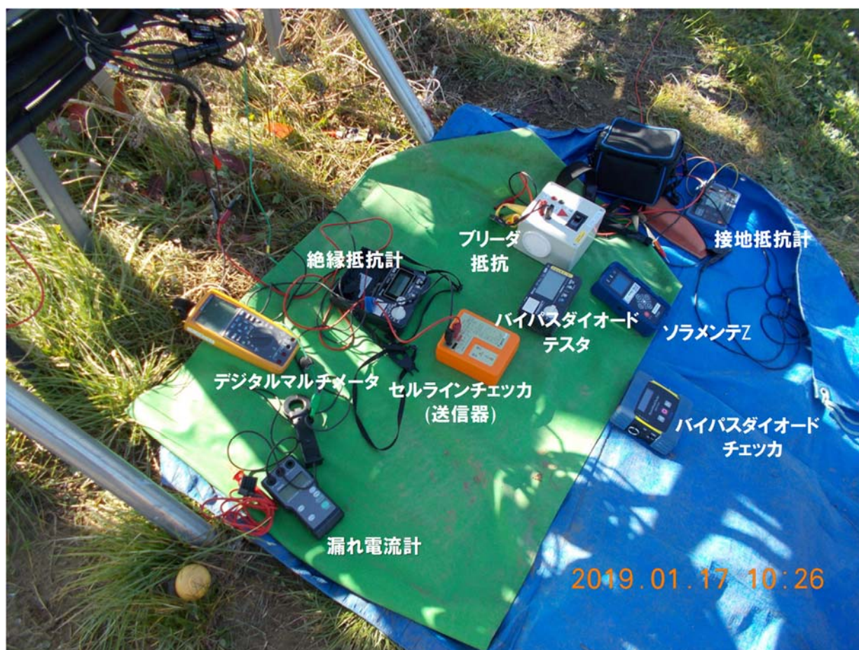
図 4.R3.11-1 調査に用いた主な測定機器
