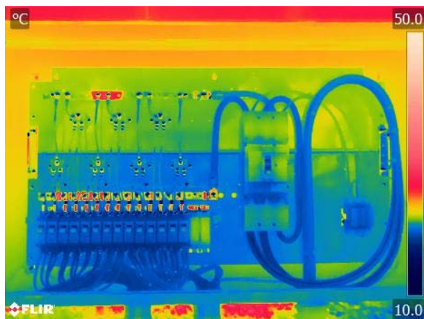
図 4.R3.3-6 接続箱内部の温度分布(接続箱#07)
