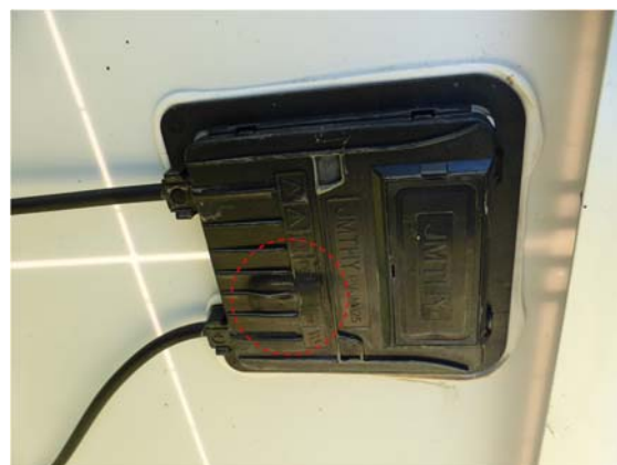
(b)カバーが変形した端子箱
