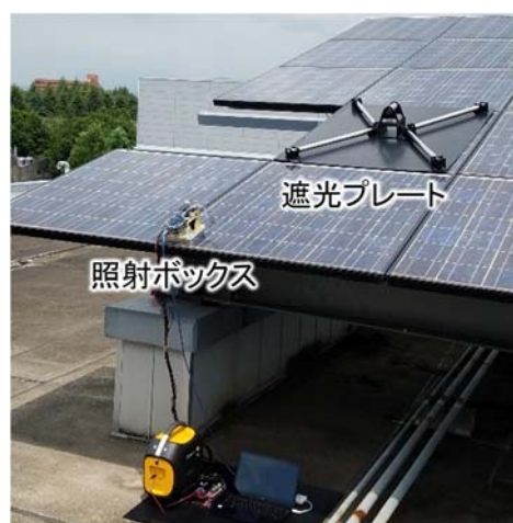
図 4-17 パルス光照射法による 現地実験の様子
