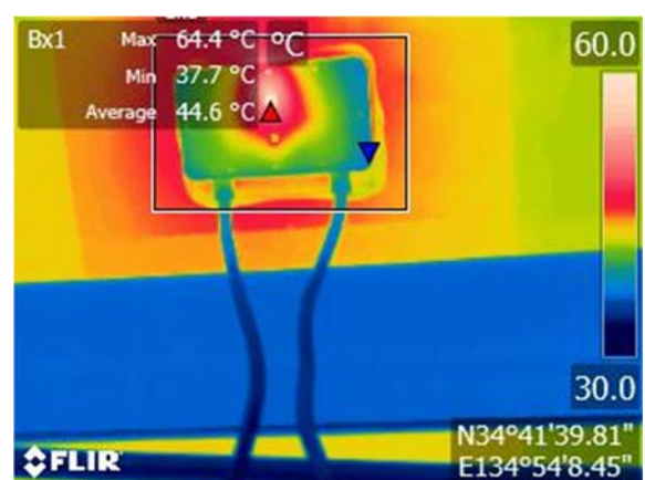
図 4.R3.8-6 #01-06 に接続されたあるモジュールの端子箱表面の温度分布
