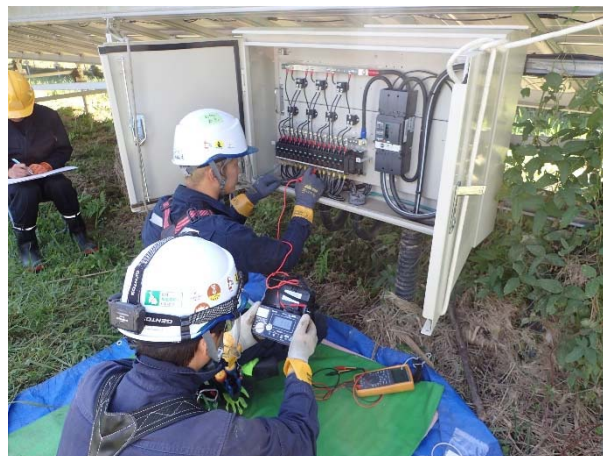
図 4.R3.3-13 絶縁抵抗を測定している様子
