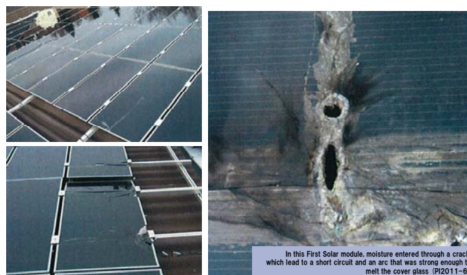
図 3.2.1-1 積雪荷重によるガラス割れによるモジュールアーク事例
