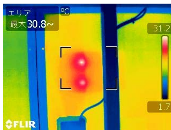
図 4.R2-28 インターコネクターセル間の接続不良による発熱の例
