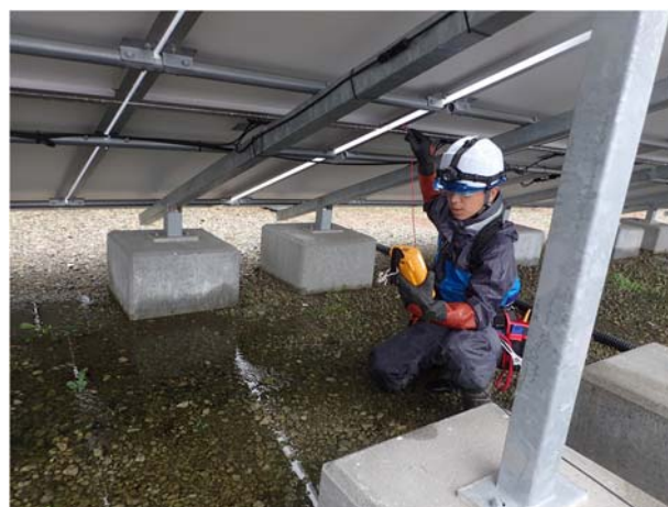
図 4.R3.6-5 モジュールフレームと接続箱内接地極との間の抵抗を測定している様子(接続箱 A)
