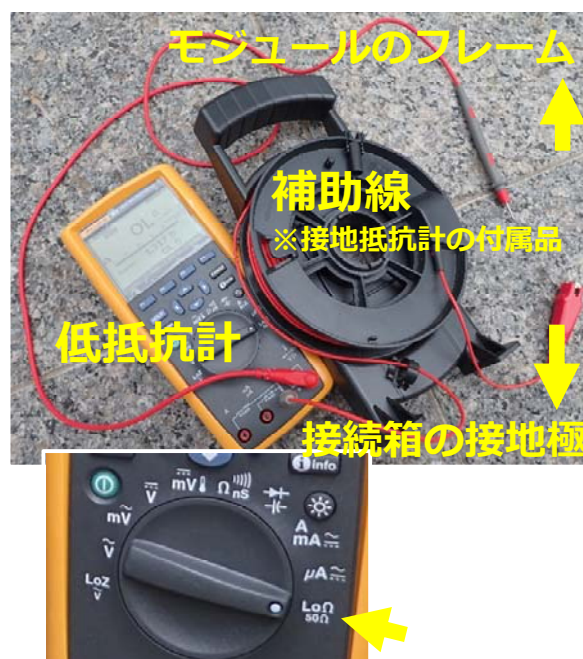
(b)低抵抗計の接続と設定
