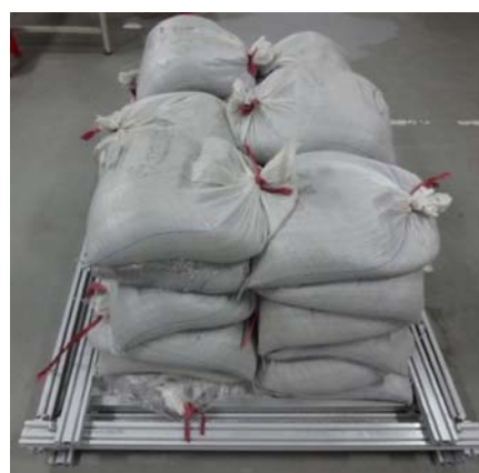
図 3.2.1-4 砂袋による終局耐力試験
