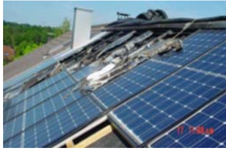
図 3.2.1-2 風による反復荷重の影響によるモジュールアーク事例
