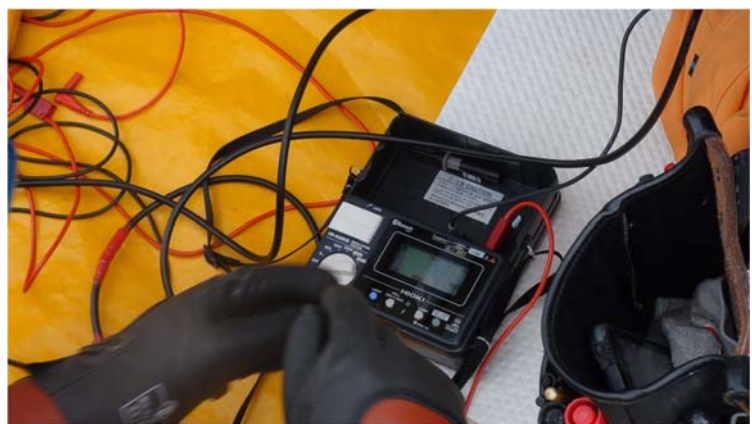
図 4.R3.6-13 絶縁抵抗計による測定
