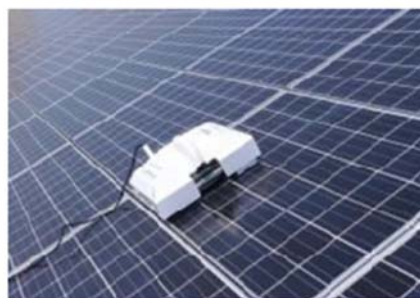
図 4-14 検査ロボット試作機の例 (写真提供: 長岡技術科学大学)
