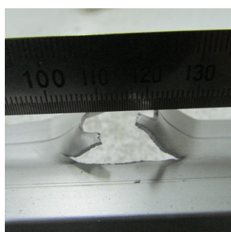
図 3.2.1-5 砂袋による終局耐力試験，二種類の破壊形態
