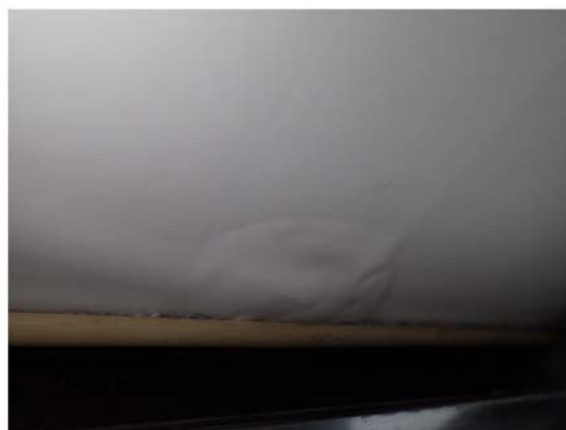
(d)バックシートの剥離 ((a)図の褐色変部の裏面)
