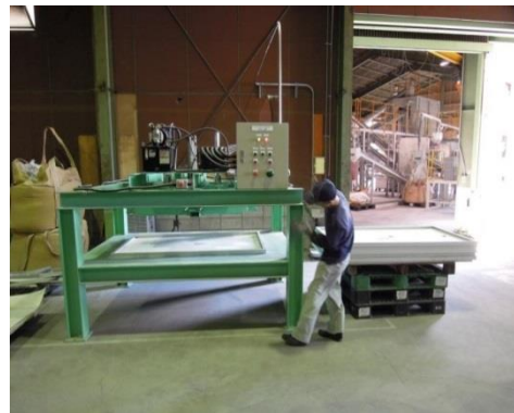
図表 31 アルミフレーム枠外し機
