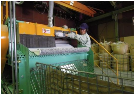
図表 32 破碎機での破碎の様子
