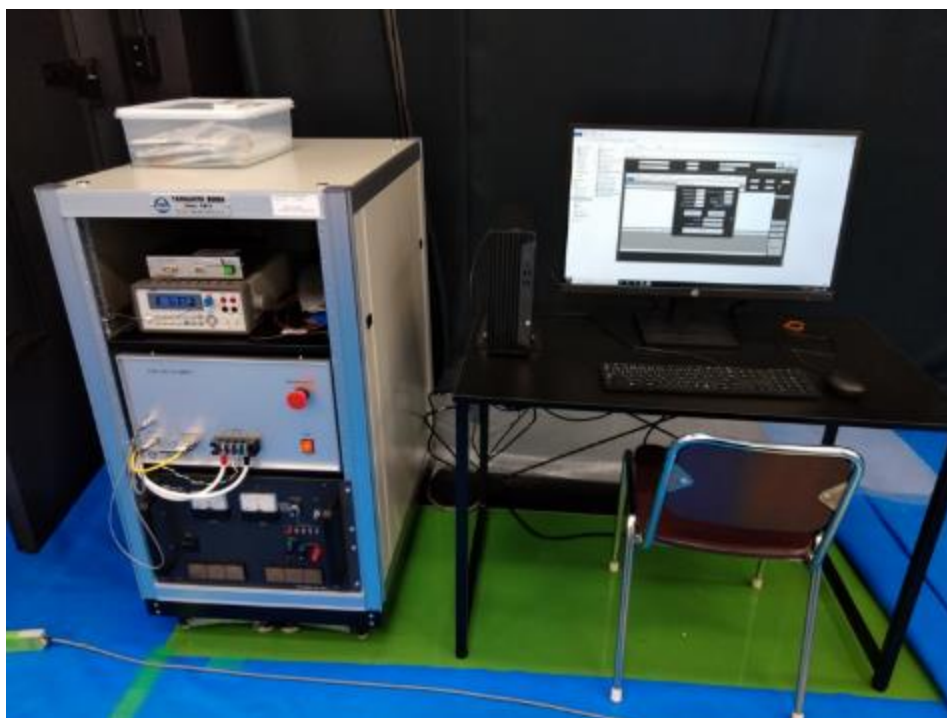
図 5-7 IV 特性評価試験装置 (MPPT 対応)
