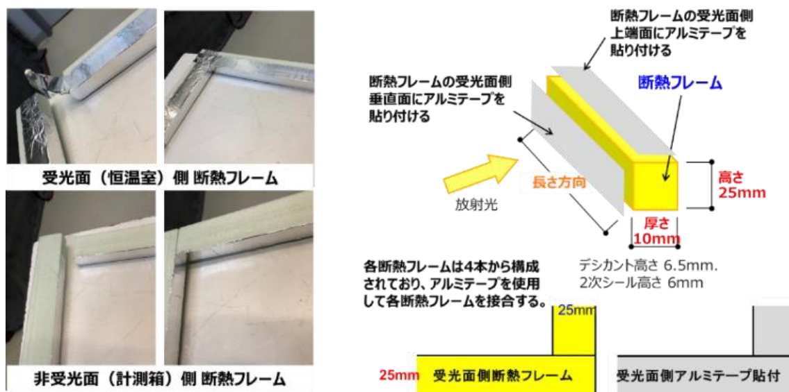
図 D-2-2 断熱フレーム詳細
