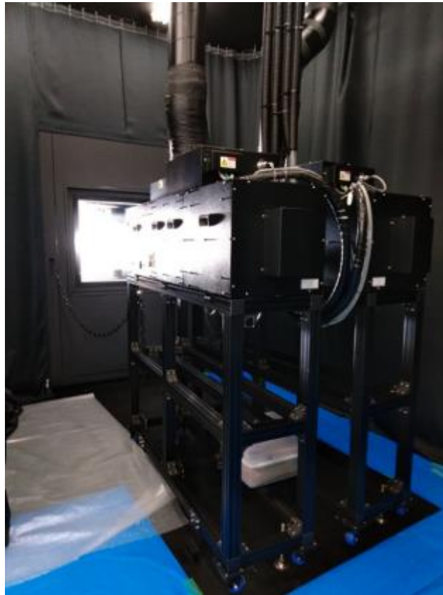
図 5-5 ソーラシミュレータの光源部(導入窓を通じた光照射時)
