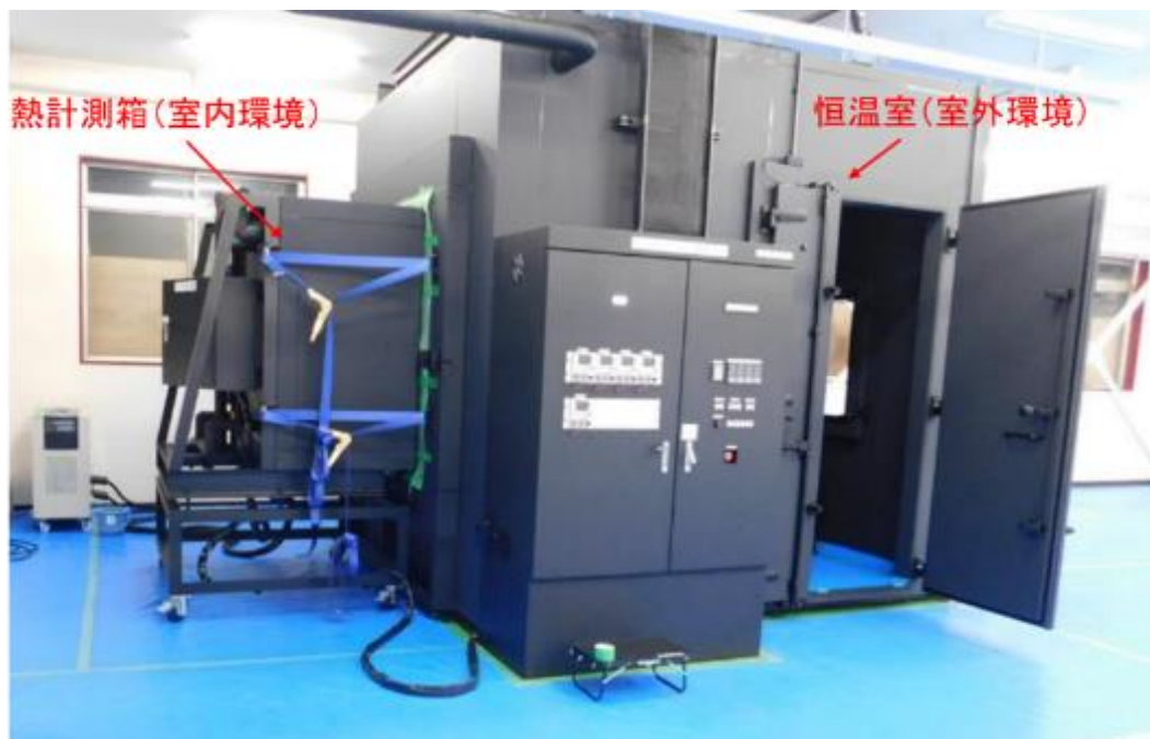
図 5-3 恒温室、制御盤、熱計測箱の外観
