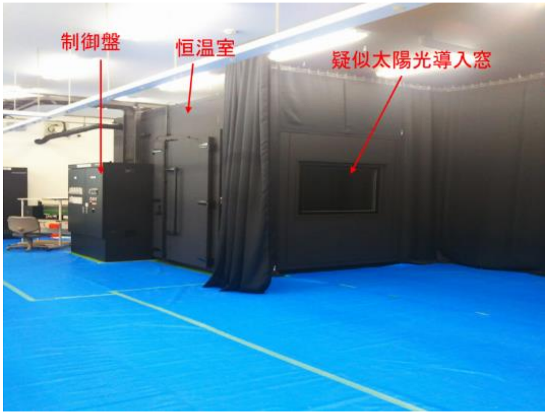
図 5-2 疑似太陽光導入窓、恒温室、制御盤の外観
