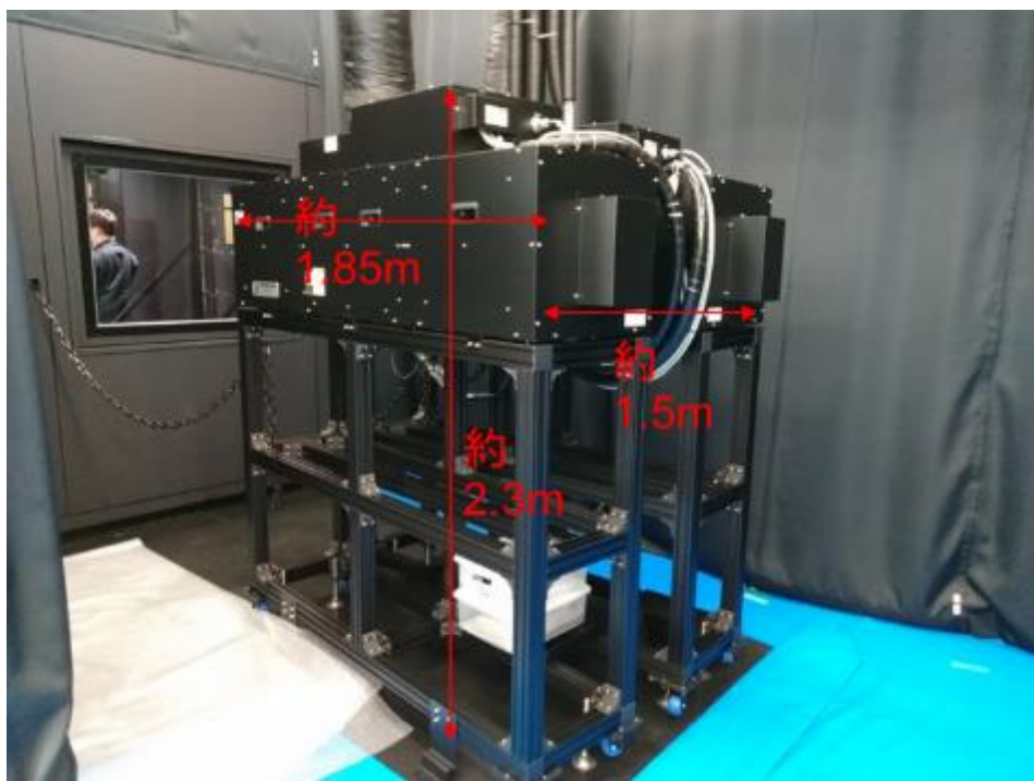
図 5-4 ソーラシミュレータの光源部(寸法)
