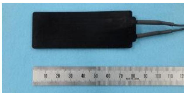
図 B-5-1 PHF-100L 83 mm×30 mm 江藤電気製
