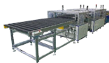
太陽光パネル リサイクル設備
