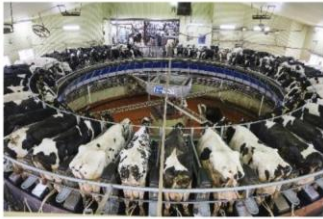
搾乳設備(ロータリーパーラー)
