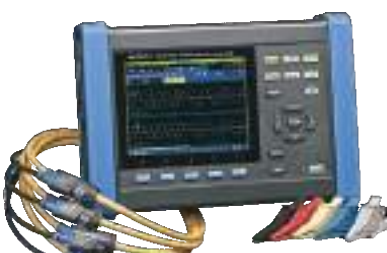
電源品質アナライザ HIOKI PQ3100-92 ＜使用前点検時の 波形・高調波測定に＞
